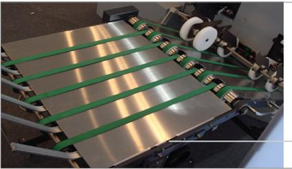
印刷機聯組輸送帶，尺寸一致聯組使用效果
