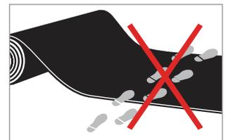
必須避免導帶於安裝過程中造成摺痕、與尖銳或突出物的摩擦及邊緣擠壓；不得將導帶直接與地面摩擦，須以布匹或紙箱加以保護、嚴謹踐踏導帶。
