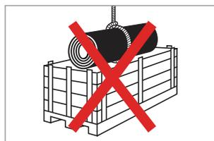
印花導帶於木箱中取出時必須使用適當的吊掛方式，須避免以繩索直接捆綁導帶而傷及印花導帶表面(如圖所示)。
